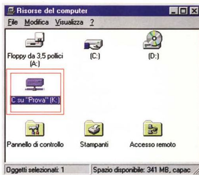
Figura 10 - Effettuata l'acquisizione della periferica condivisa, all'interno della cartella "Risorse del computer", apparirà l'icona relativa al nuovo hard disk. A questo punto potremo utilizzare il suo contenuto (limitatamente al tipo di accesso al quale siamo abilitati) come se fosse sulla nostra macchina.
